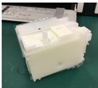
図 3. 取り外したインクタンク
