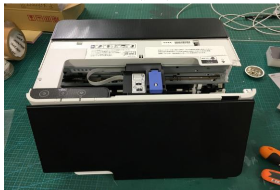
図 1. 蓋状のパネルまで取り外した状態
