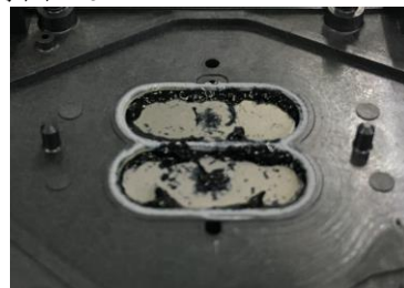
図 10. インク流路内の分解後の様子
