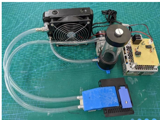
図 2. 水冷式冷却装置の構成
