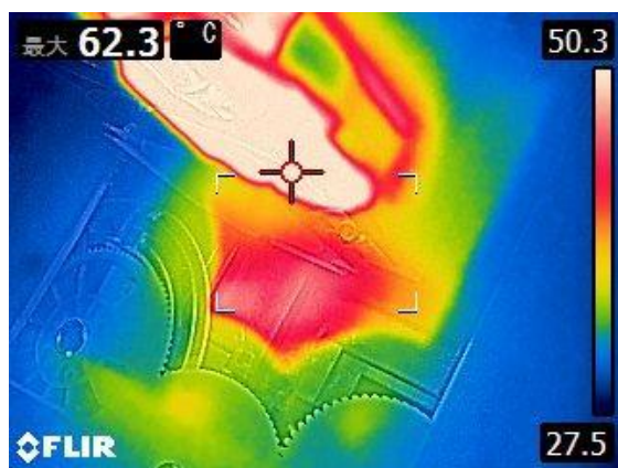
図 7. LED 点灯開始から 5 分後(冷却装置未稼働)
