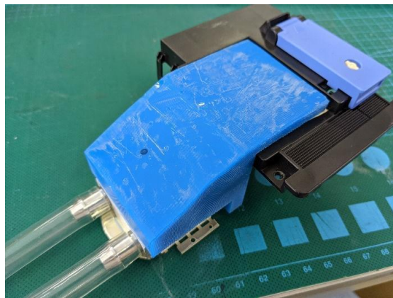
図 3. UV-LED をプリンタヘッドカバーへ装着した様子
