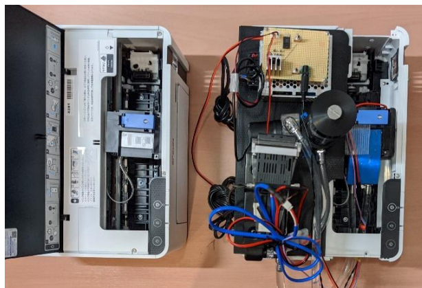
図 4. 改造箇所比較写真・上面 (左: 改造前 / 右: 改造後)
